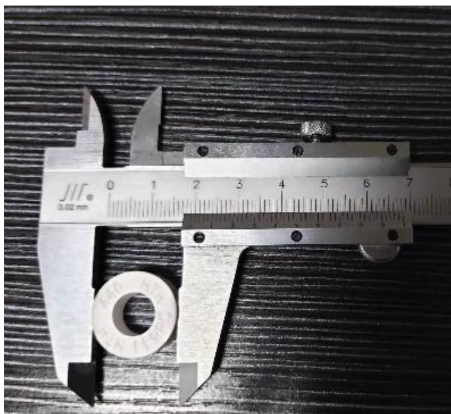
Рис 27. Температурное измерительное кольцо и метод измерения
