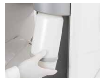
Устройство SANASPRAY Ёмкость с дистиллированной водой вместо водопроводной воды.
